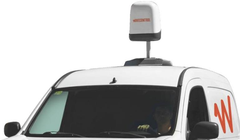
*Ilustración 6. Estación MonitEM instalada en un coche*
